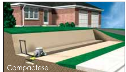
Instale caño de drenaje, roca de grava y nivele
